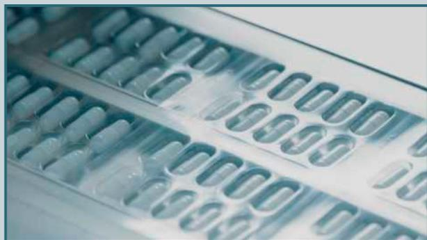
**MATERIALES TRIPLEX:** Composición ABC PVC-PE-PVDC. Es un tipo de composición que se utilizaba mucho antes porque el Polietileno de la capa intermedia aseguraba mucho la adhesión entre el PVC y el PVDC, pero actualmente los DUPLEX ya dan un excelente resultado de unión entre capas.
